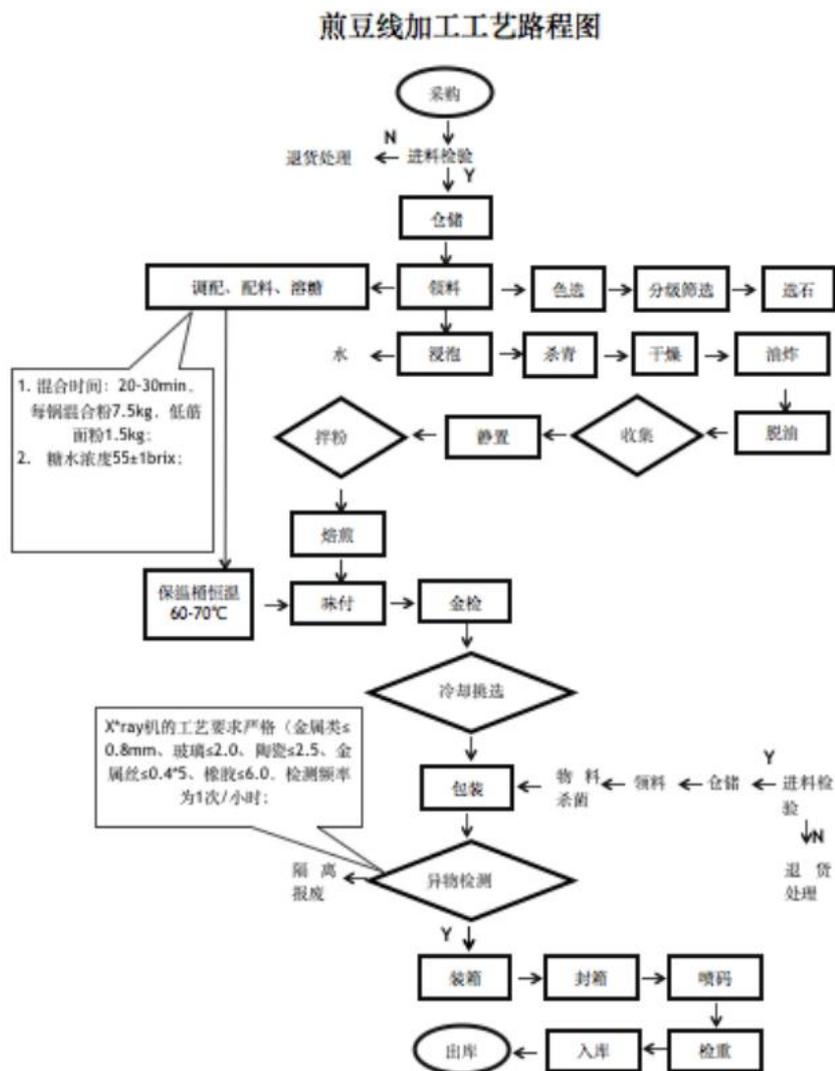
图 1-2 生产工艺流程图
